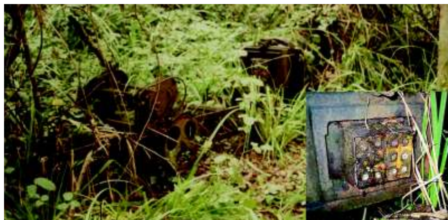
Línea de extrusión entre la maleza. Detalle de la boquilla con el último barro extrusionado.
