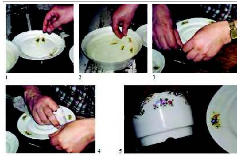
Lám. 6: proceso de decoración por calcomanía: 1 recortar; 2 mojar; 3 pegar; 4 retocar y secar; 5 antes y después de la cocción.
