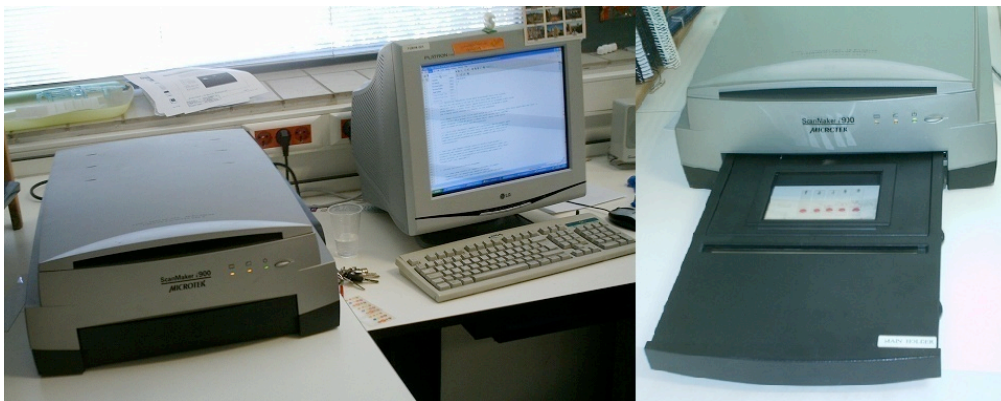
Figura 22. Escáner ScanMaker i900 con el que se han realizado las medidas de color.
