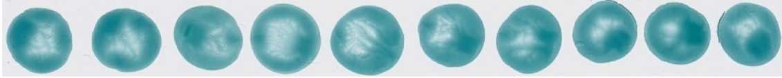
Figura 40. Imagen de las 10 membranas con las que se ha estudiado la precisión intermembrana, donde se observa que no todas tienen la misma forma ni el mismo diámetro.
