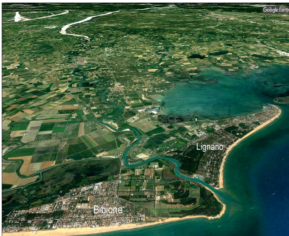
Fig. 30 – La forma cuspidata dell'apparato deltizio del Tagliamento è legata alla prevalente energia del moto ondoso che, grazie alle frequenti mareggiate dovute ai venti sciroccali, è in grado di ridistribuire lungo costa il materiale abbandonato alla foce. Il delta si è formato durante gli ultimi 2.500 anni. Si ritiene possa essere stata la diretta conseguenza di una deforestazione della pianura (sviluppata specialmente dai Romani) che ha accelerato i processi erosivi fluviali con redistribuzione verso valle dei materiali mobilizzati.
