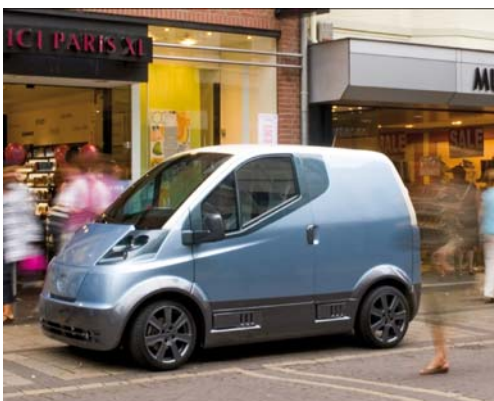
QUICC! DiVa (DistributionVan) – ελαφρύ πλαστικό ηλεκτρικό όχημα της DuraCar ( www.Quicc.eu )
