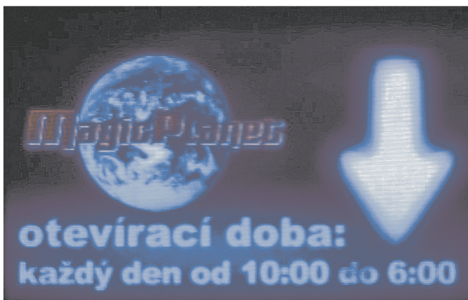
Obr. 8.7: Proměnlivá informace – obrazce se mohou libovolně měnit díky počítačem řízené matici ze světelných diod [7]
