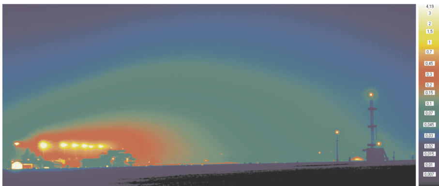
Obr. 8.22: Příklad špatně navrženého osvětlení odbavovací plochy na letišti pomocí svítidel s nesymetrickou vyzařovací charakteristikou
