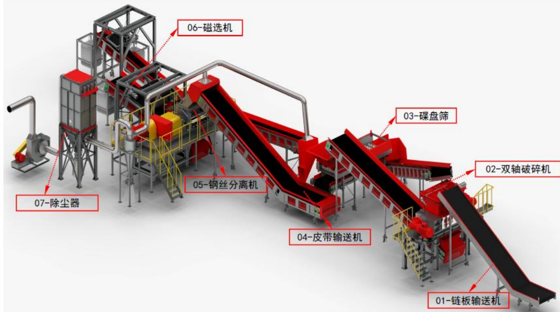
图 2-3 废塑料常用制备工艺
