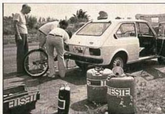
Com a instalação da quinta roda, medições exatas.
