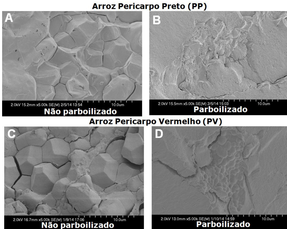
Figura 29 - Micrografia de microscópio eletrônico de varredura (MEV) de arroz com pericarpo preto (PP) e arroz com pericarpo vermelho (PV) não parboilizado e parboilizado com foco em seus endospermas.
