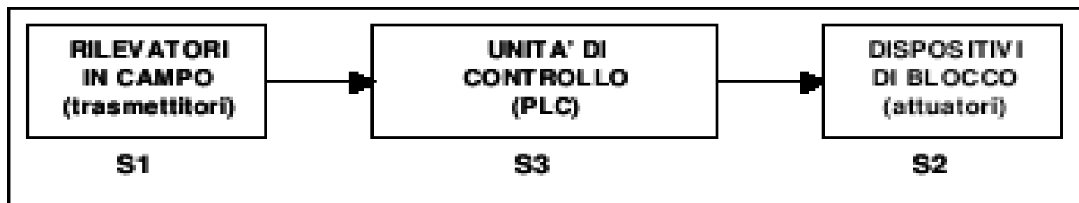
Fig.1 - Schema generale di un sistema di sicurezza
