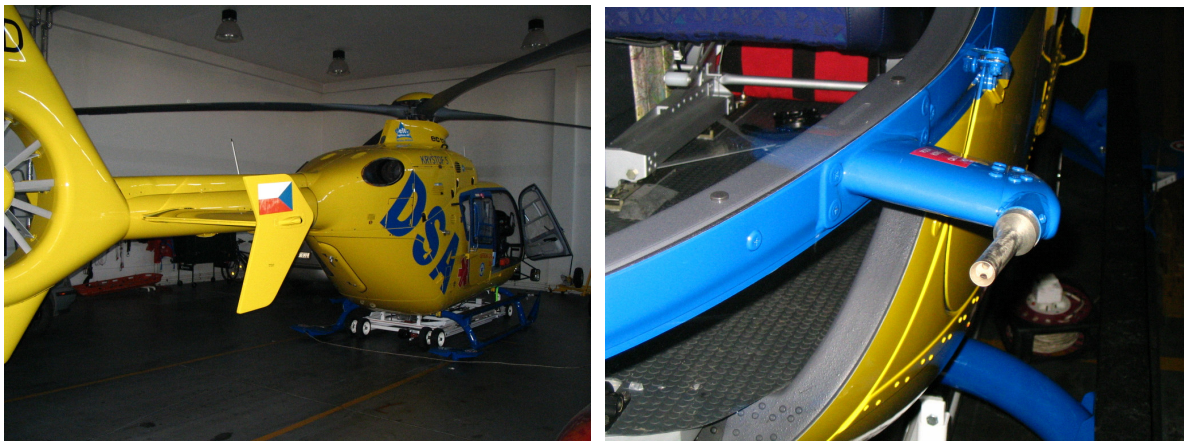
obr. 8.23 Vrtulník a detail vrtulníku s Pitotovou trubicí
