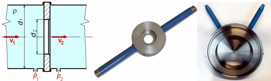
obr. 8.30 Schéma clony a průmyslově vyráběná clona centrická a excentrická
