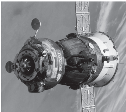
Figura 3. El vehículo espacial ruso “Soyuz”. Pueden apreciarse los tres elementos de los que consta: el Módulo Orbital, en la parte delantera, tiene una forma casi esférica, contiene el equipo necesario para la supervivencia de la tripulación y es abandonado en el espacio para su destrucción justo antes de la reentrada en la atmósfera. La Cápsula de la Tripulación, en la parte central, es la única parte del vehículo que regresa a la Tierra, por lo que va equipada con un escudo térmico y dos paracaídas, uno primario y otro de emergencia. Tiene forma de campana y en su interior pueden ir hasta tres tripulantes. Por último, el Módulo de Servicio, el segmento trasero, de tono más claro, con forma cilíndrica, contiene los motores orbitales y los tanques de combustible. Tras frenar la nave para volver a la Tierra, se separa de la cápsula y es destruido en la atmósfera. Foto: NASA.
