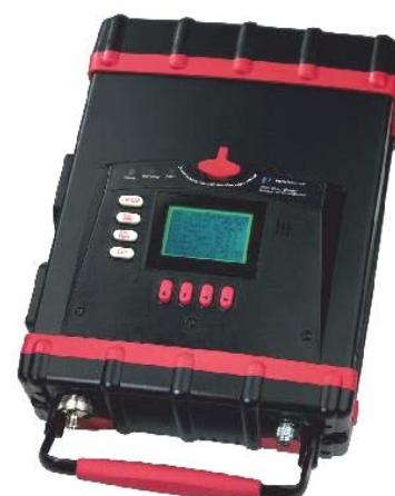
Rys 3. Przenośny chromatograf gazowy Voyager
