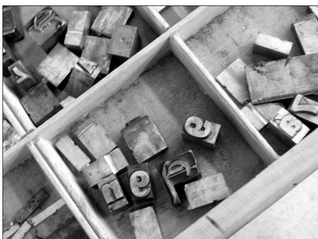
Tipos de plomo para composición manual en frío. Caracteres de la Fundición Richard Gans, Madrid.
