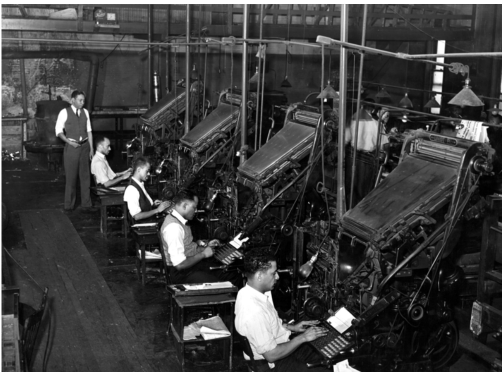
Taller de composición tipográfica con varios operadores sobre máquinas de Linotipia.
