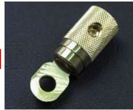
23019 Ringöse für 35 mm 2 mit Schraube 1 Stk. Massive Anschlussklemme mit Inbusschrauben. Lochdurchmesser 8,5 mm.
