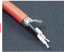
24891 Monocinchleitung BERLIN rot matt 25 m Symmetrischer Aufbau und doppelte Abschirmung. Die Innenleiter sind aus versilbertem OFHC Kupfer.
