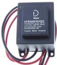
440 Entstördrossel 15/45 Ampere Die Drosseln 440 und 442 unterdrücken Störspannungen der Lichtmaschine und getakteter Netzteile. Die Auswahl erfolgt nach dem zu erwartenden Dauerstrom.
