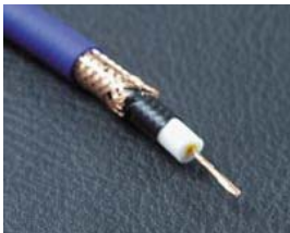
24491 Monocinchleitung LONDON blau 25 m 75 Z(Ohm) koaxiales doppelt abgeschirmtes Cinchkabel auch für digitale Ton u. Bildübertragung geeignet (DVD) Kupferqualität: Monokristallinem UP-OFC Kupfer.
