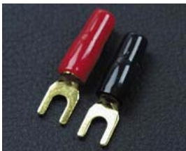
23021 Gabel für 4/6 mm 2 /d=4,2 mm 8 Stk. Vergoldete Gabeln in Industriequalität. Je 4 Stück mit roter und schwarzer Tülle.
