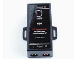
660 NF-Entstörfilter 20 Hz - 38 kHz Mehrfache Masseverbindungen auf Vorverstärkerebene wirken wie ausgelegte Empfangsantennen für Bordnetzstörungen. Das Filter beseitigt die Störungen durch galvanische Trennung.
