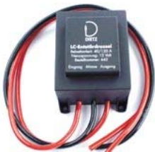
442 Entstördrossel 40/120 Ampere LC-Filter, bestehend aus einer Hochleistungsentstördrossel und mehreren verschalteten Kondensatoren. Belastung 40 A Dauerstrom und 120 A Spitzenstrom.
