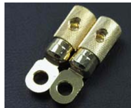
23020 Ringöse für 20 mm 2 mit Schraube 2 Stk. Massive Anschlussklemmen mit Inbusschrauben. Lochdurchmesser 8,5 mm.
