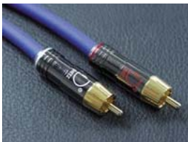
24450 Cinchleitung LONDON 5 m blau 75 Z(Ohm) koaxiales doppelt abgeschirmtes Cinchkabel, auch für digitale Tonübertragung, Monokristallinem UP-OFC Kupfer. C(pF/m):67,66-L(µH/m):1,28-R(mOhm/m):74,6
