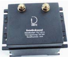
444 Entstördrossel 75/160 Ampere L-Filter, das auch höchsten Anforderungen an Dauerbelastung gerecht wird. Aufnahme der Kabel bis 70 qmm über M8-er Stehbolzen. 75 A Dauerstrom und 160 A Spitzenstrom.
