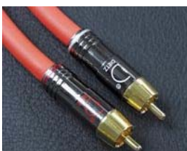
24807 Cinchleitung BERLIN 0,75 m rot matt Symmetrisches High-End-Cinchkabel, Ø 8,5mm, Innenleiter aus versilbertem OFHC-Kupfer, vergoldete Cinchstecker C(pF/m):81,53-L(µH/m):1,22-R(mOhm/m):58,73-Z(Ohm/m):122,33 Klang: "Spitzenklasse", autohifi 5/98
