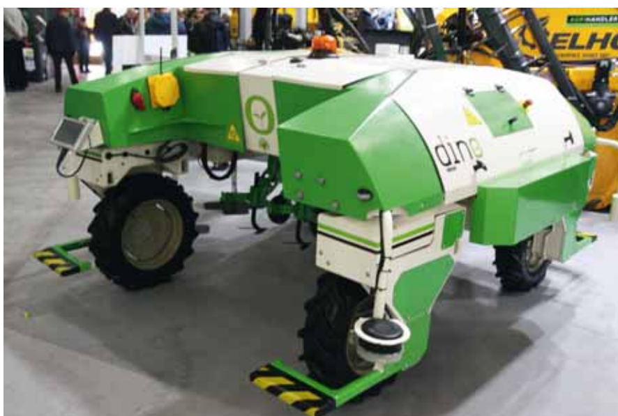
Naio DINO – autonomiczny robot odchwaszczający francuskiej firmy Naio Technologies
