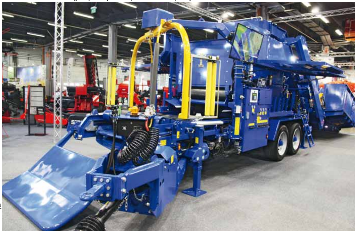
KOMBI LT-Master – wielkogabarytowa prasowijarka austriackiej firmyGoweil
