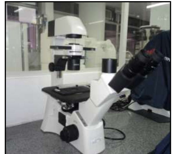
Figura 04. Microscópio invertido trinocular. Equipamento do laboratório de cianobactérias da URCQ/SUEST/FUNASA-PE
