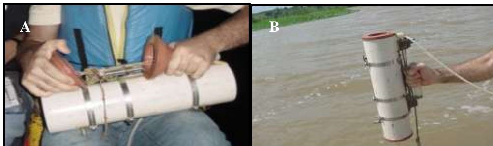
Figura 3. A e B: Vista do momento de preparação e recolhimento da garrafa de Van Dorn.
