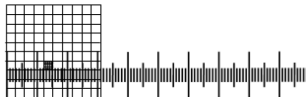
Figura 16. Sobreposição do retículo de Wippler sobre a lâmina micrométrica.
