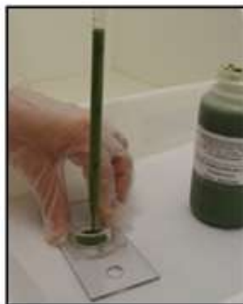
Figura 08. Pipeta graduada utilizada durante transferência de amostra para cubeta de Utermöhl .
