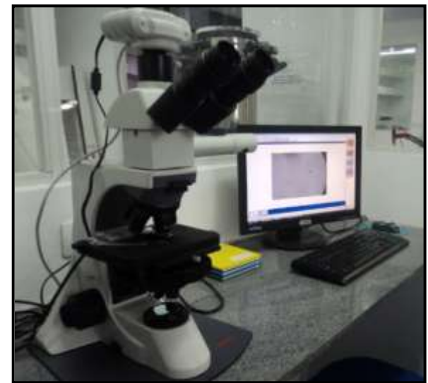
Figura 03. Microscópio biológico trinocular com sistema de captura de imagem. Equipamento do laboratório de cianobactérias da URCQ/SUEST/FUNASA-PE.
