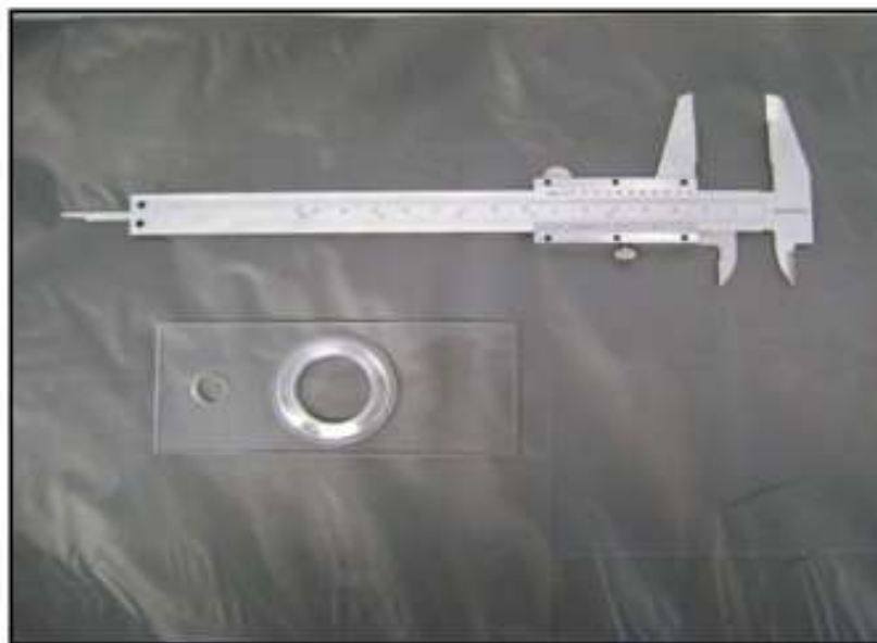
Figura 29. Paquímetro profissional e base da câmara ou cubeta de Utermöhl .
