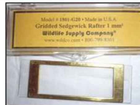
Figura 06. Câmara de sedgewick Rafter .
