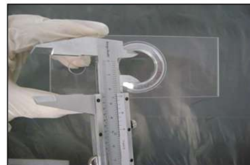
Figura 30. Demonstração do ajuste do paquímetro sobre a porção interna da cubeta de Utermöhl .
