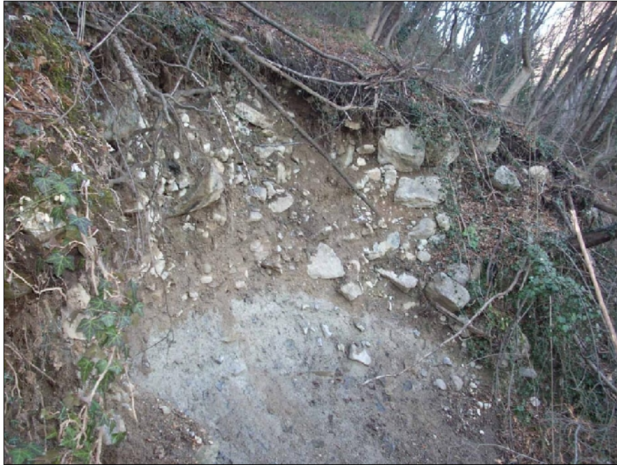
Fig. 8: dettaglio della scarpata principale; si nota la presenza dei due livelli descritti nel testo e di piante e blocchi in equilibrio precario sul coronamento della frana.
