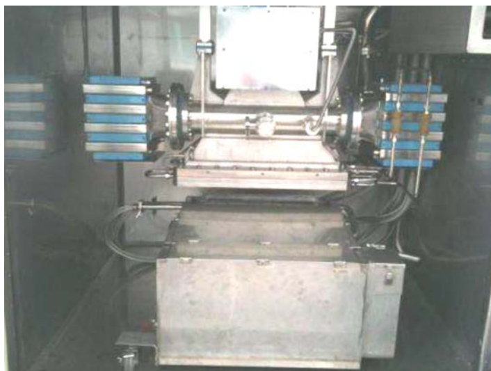
Rys. 14. Widok komory obróbki radiacyjnej z osłoną lokalną w instalacji mobilnej zbudowanej w Korei przez firmę EB Tech.
