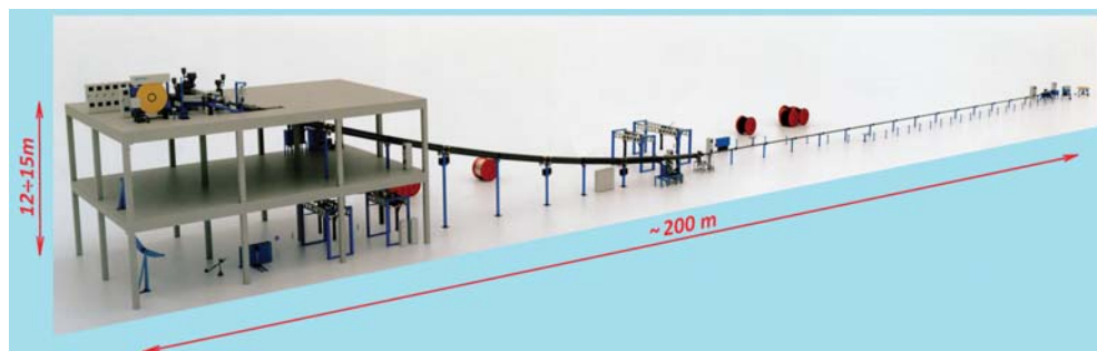
Rys. 5. Linia technologiczna wulkanizacji w rurach łańcuchowych w osłonie azotu w temperaturze 400°C i przy ciśnieniu 12÷20 bar
