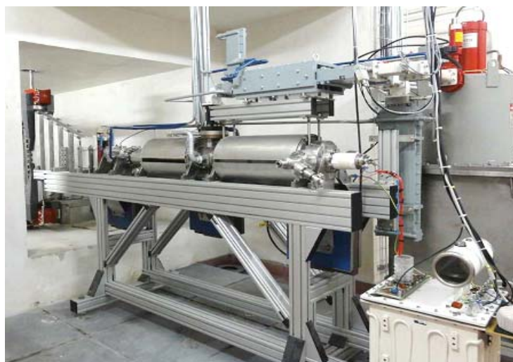
Rys. 9. Widok ogólny liniowego akceleratora elektronów z falą bieżącą zbudowany przez firmę CoRAD z Rosji
