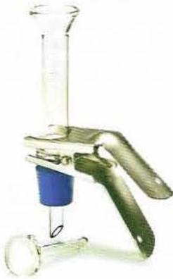
Configuración de cilindro graduado para la fácil medición del líquido.
