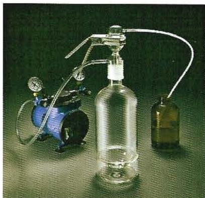
Para la filtración cerrada y transferencia de disolventes de botella a botella, convertible a filtración abierta usando el embudo de 300 ml.
