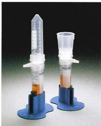
Las unidades de filtración Steriflip se acoplan a un tubo de 50 ml para centrifuga (izquierda) o el embudo accesorio de 50 ml (derecha).
