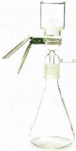
Base y embudo de vidrio (rejilla-soporte de acero inoxidable opcional) con conector de vacío y matraz de recogida conectado por juntas internas y externas de vidrio esmerilado.
