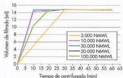
Condiciones de centrifugación: 4.000 g con rotor de cabezal basculante a 25 °C, 15 ml de muestra.
