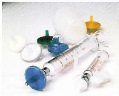
Hay unidades de filtración Millex de 4, 13, 25, y 50 mm de diámetro para filtrar volúmenes de 1 ml a 4 l.
