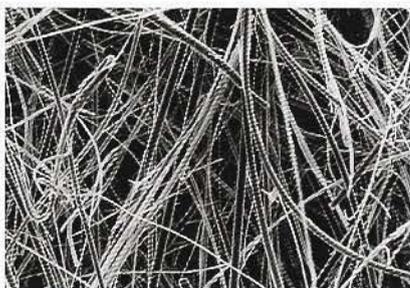
Los discos fibrosos Millipore están disponibles en una amplia gama de caudales y capacidades. Hay filtros de fibra de vidrio con o sin resinas ligantes y pueden esterilizarse con EO, radiación gamma o en autoclave (121 °C a 1 bar).
