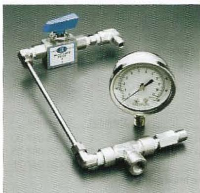
Está disponible un aparato para el ensayo del punto de burbuja. El ensayo de punto de burbuja puede realizarse en un portafiltros ensamblado que tenga el filtro instalado.
