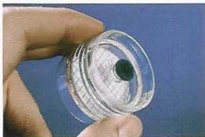
Hay cassettes con un sólo filtro y configuraciones de peso idéntico para análisis gravimétricos.
