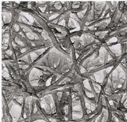
Los cartones de soporte de celulosa se utilizan para reforzar los filtros de los monitores Millipore para el análisis de contaminación. Cuando se saturan con medio de cultivo, también pueden utilizarse para cultivar microorganismos en membranas.
