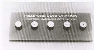
Los orificios mantienen un flujo de aire constante durante el muestreo.
