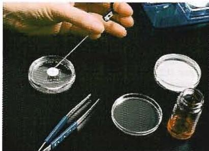
Estos discos de membrana de ésteres mezclados de celulosa suponen una forma eficaz de dializar microvolúmenes de soluciones proteicas o ácidos nucleicos con alta recuperación (<100  $\mu\text{l}$ ). Con la técnica de "diálisis en gota", un disco de filtro frotante sustituye la bolsa de diálisis.
