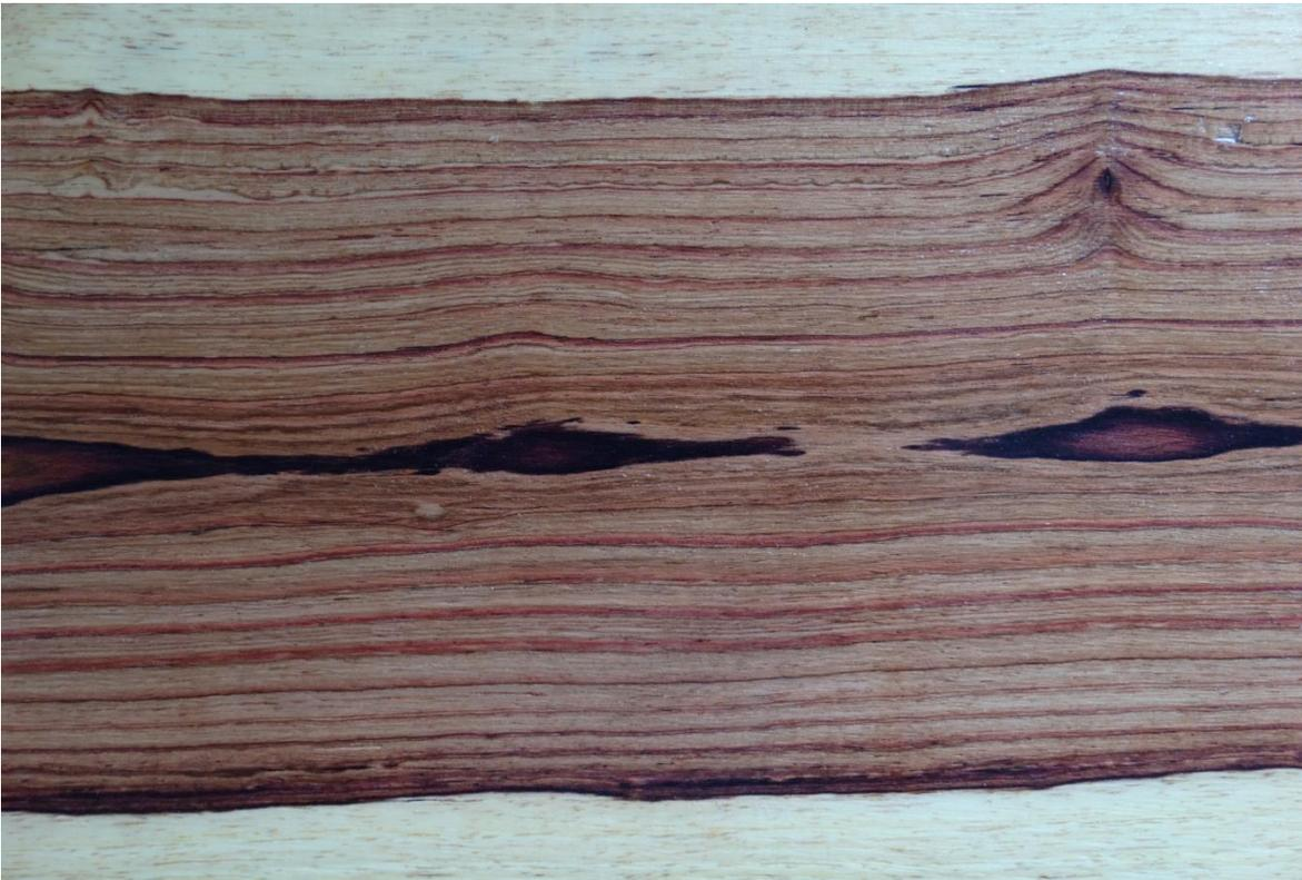
Figura 33. Vista longitudinal radial de la madera de *D. stevensonii*. En la figura 33 se observa el diseño cromático con líneas paralelas marcadas por los anillos de crecimiento, en el que sobresalen los tonos púrpura, café y negro.
