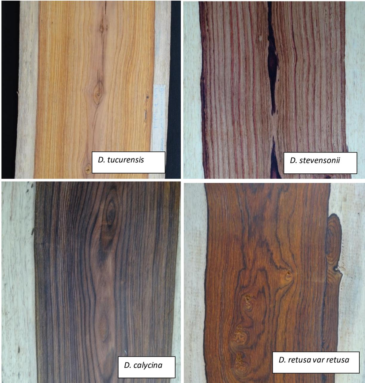
Figura 171. Madera en corte longitudinal radial de las 4 Dalbergias.
