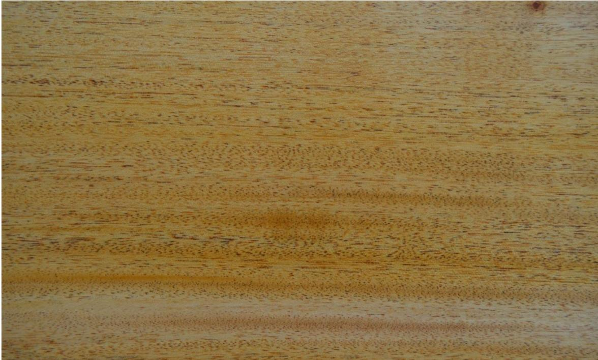
Figura 101. Vista Longitudinal Radial de la madera de *S. macrophylla* con diseño en líneas poco diferenciadas.
