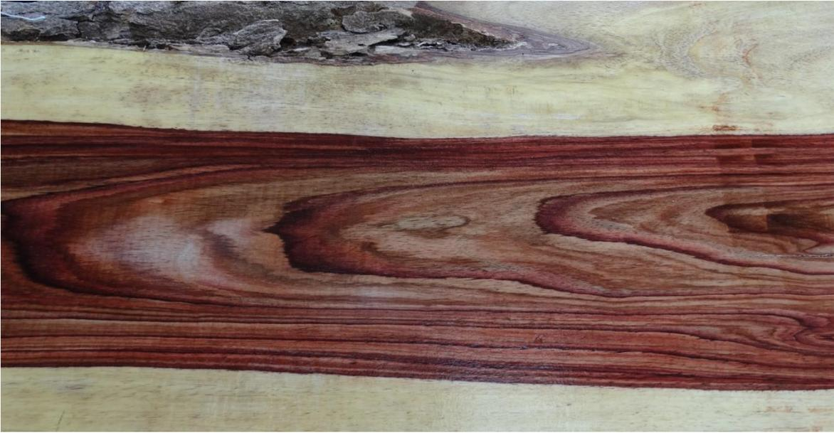
Figura 34 Vista longitudinal tangencial de la madera de *D. stevensonii*, en la que sobresale el diseño cromático con dibujo elíptico o de arcos concéntricos.
