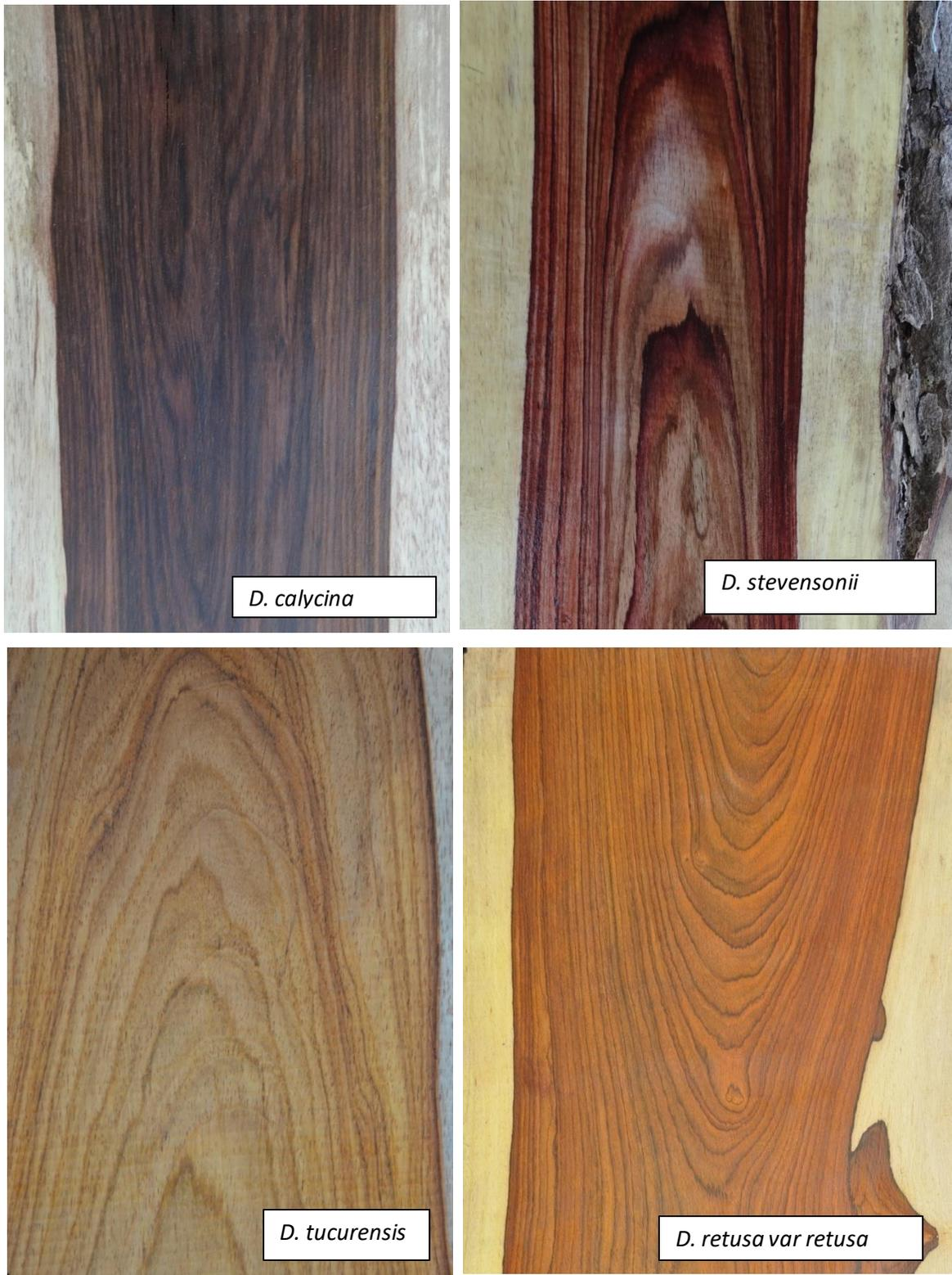
Figura 172. Vista tangencial de la madera de las 4 Dalbergias. Todas de diseño cromático con arcos superpuestos
