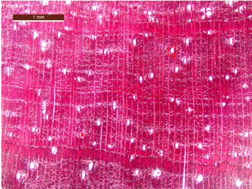
Figura 36. Vista del corte transversal de la albura de *D. stevensonii* al DAP. 2.5x. Hay bandas de fibras al final de los anillos de crecimiento.
