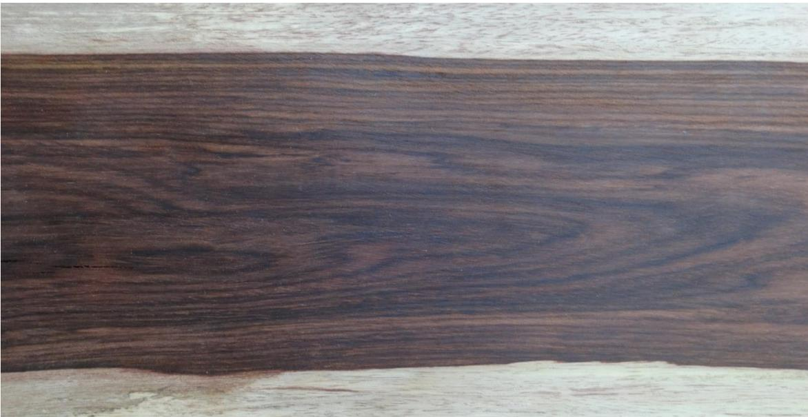
Figura 56. Vista Longitudinal Tangencial de una tabla de *D. Calycina* con diseño de arcos superpuestos.
