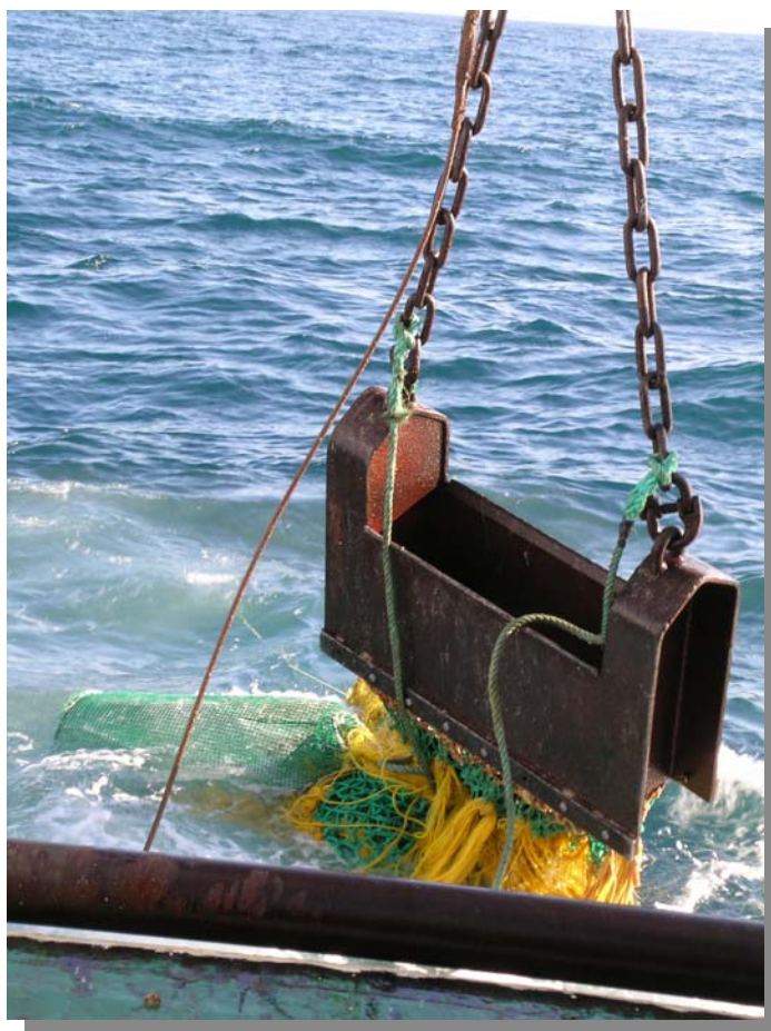
Figura 11. Draga de roca utilizada en la campaña PALAMOS08
