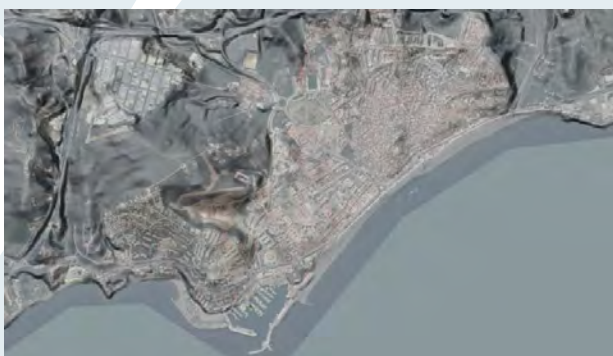
Resultado de la fusión del mapa de sombras y el mapa de pendientes derivado del modelo digital del terreno de Andalucía.
