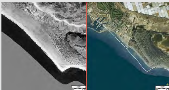
Modificación por construcción de infraestructuras costeras y erosión de la línea de costa entre dos años de referencia.
