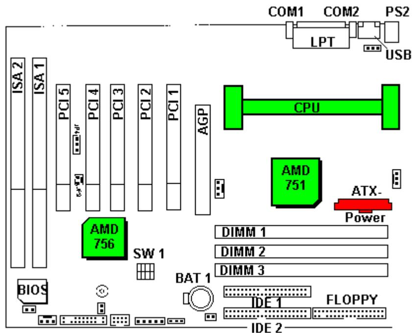
Prinzip-Schaltbild eines Mainboards mit AMD-ATHLON-Prozessor (August 2000)
