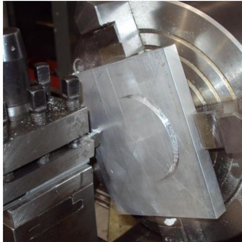
Figura No.13. Trepanando la placa para hacer el hueco en el portarretrato.
