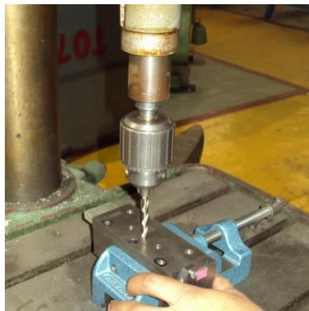
Figura No.12. Dispositivo de barrenado, utilizando una prensa comercial.
