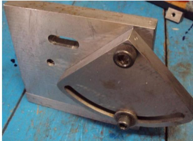
Figura No.11. Montaje diseñado y fabricado con 2 placas de acero comercial.
