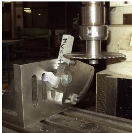
Figura No.10. Montaje para ubicar y sujetar el portaplumas.
