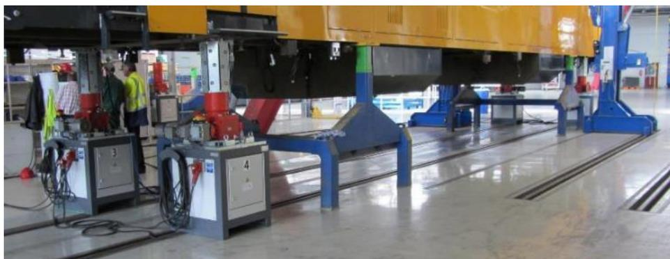
Bestimmung der Belastung, die der Fahrzeugaufbau auf das Drehgestell ausübt
