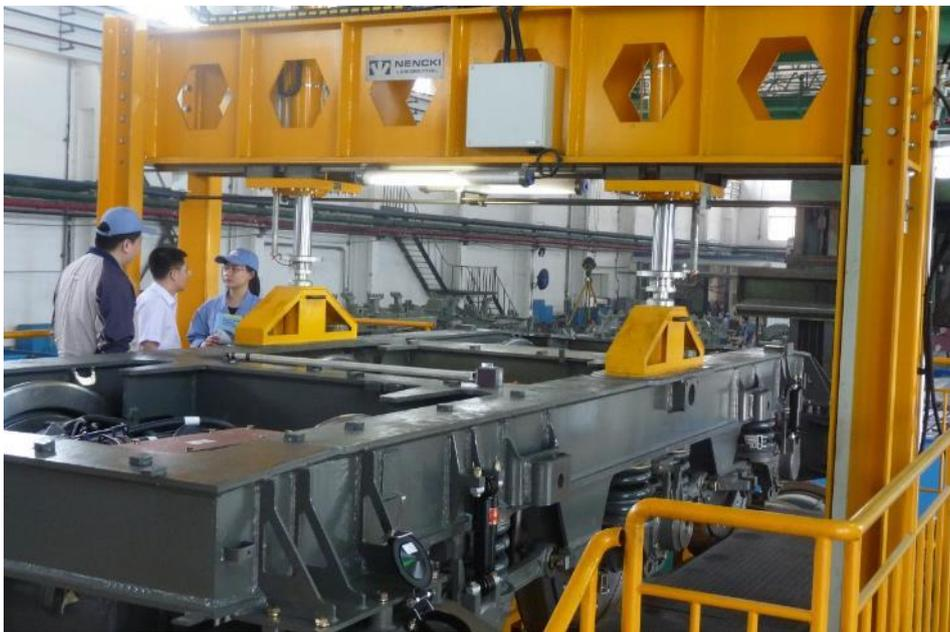
Überprüfung der Lastverteilung und weiterer Einstellungen am Drehgestellprüfstand
