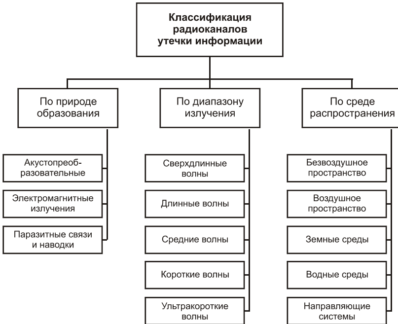
Рис. 5.2. Классификация радиоканалов утечки информации
