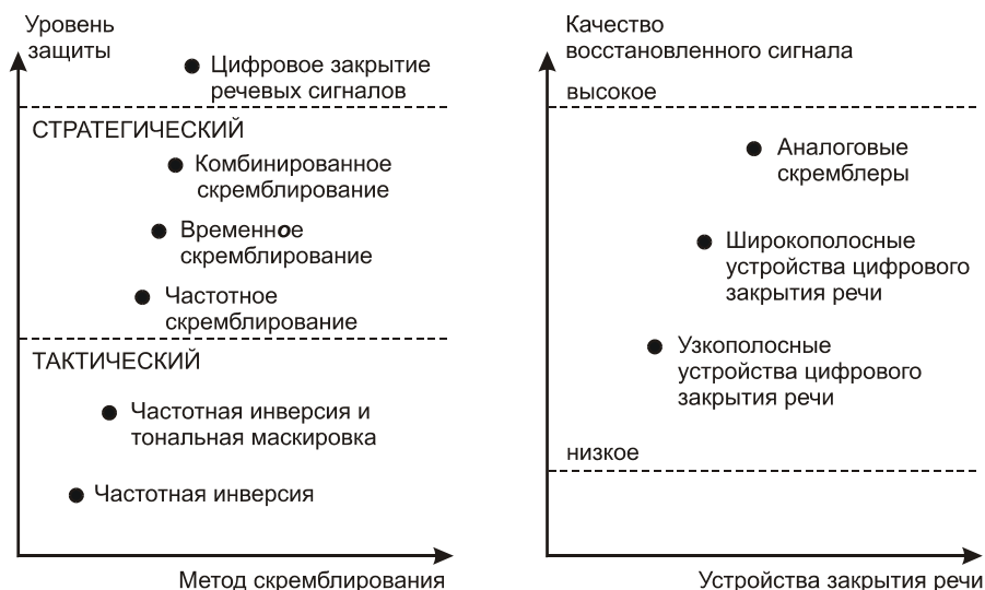
Рис. 19.5. Сравнительные диаграммы разных методов закрытия речевых сигналов
