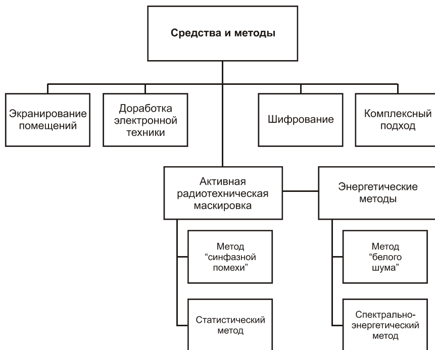
Рис. 11.2. Способы и методы ЗИ, обрабатываемой средствами электронной техники, от утечки по радиотехническому каналу
