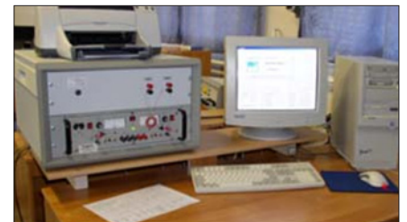
Obr. 3. Stanoviště pro měření magnetických vlastností konstrukčních materiálů
