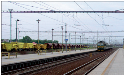
Obr. 1. Trať elektrizovaná stejnosměrnou trakční soustavou 3 kV
