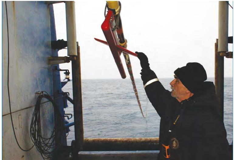
Устройство контроля глубины DigiBIRD на сейсмической косе DigiSTREAMER.
