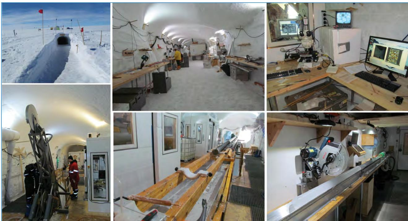
Подземные конструкции EastGRIP. Верхний ряд: вход; научная траншея, где ведется обработка керна; изучение физических и кристаллографических свойств образцов вновь пробуренного ледяного керна. Нижний ряд: буровая вышка в действии; буровая колонка после извлечения керна; первичная обработка ледяного керна.
