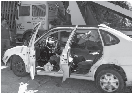
Deformación en el volante de la dirección
