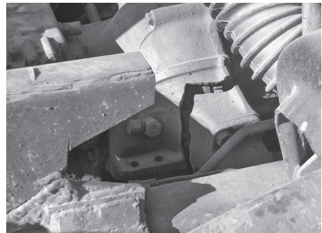
Daños en la estructura inferior del camión por transmisión de fuerza
