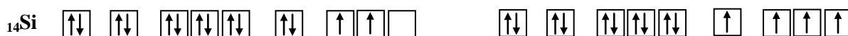
Obr. 1.4 Základní stav atomu křemíku s^2 p^2 a excitovaný stav atomu křemíku s p^3
