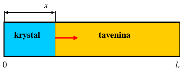
Obr. 8.8 Princip směrové krystalizace
