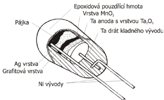
Obr. 5.27 Řez kapkovým tantalovým kondenzátorem s tuhým elektrolytem
