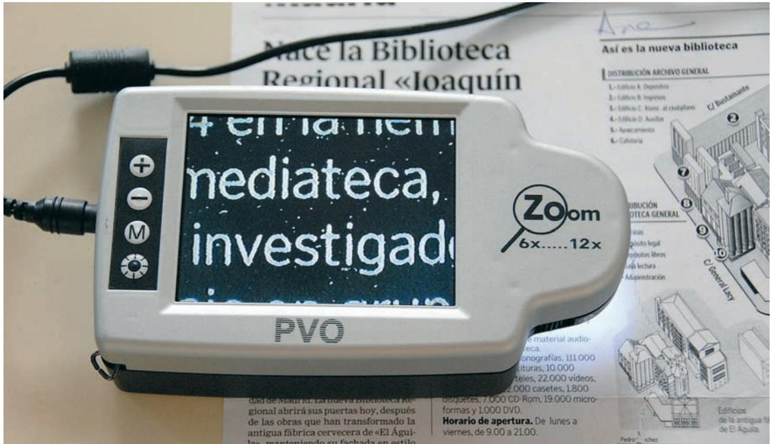
Lupa electrónica portátil PVO. Exposición de Productos de apoyo del CEAPAT.
