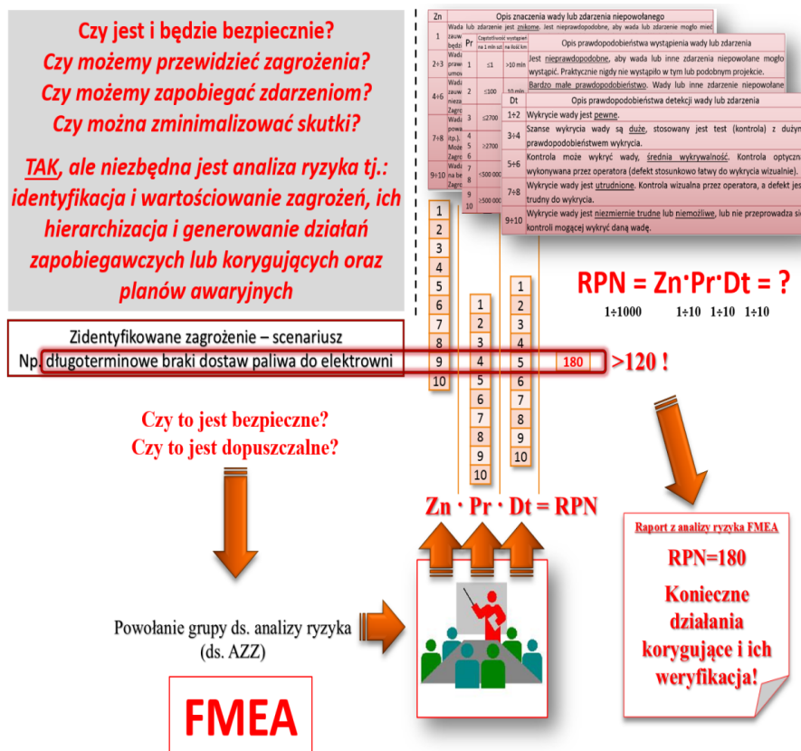
Rysunek nr 2: Proces wartościowania zagrożenia z wykorzystaniem metody FMEA i tablic wskaźników wraz z opisami dostosowanymi do specyficznych wymagań branżowych
