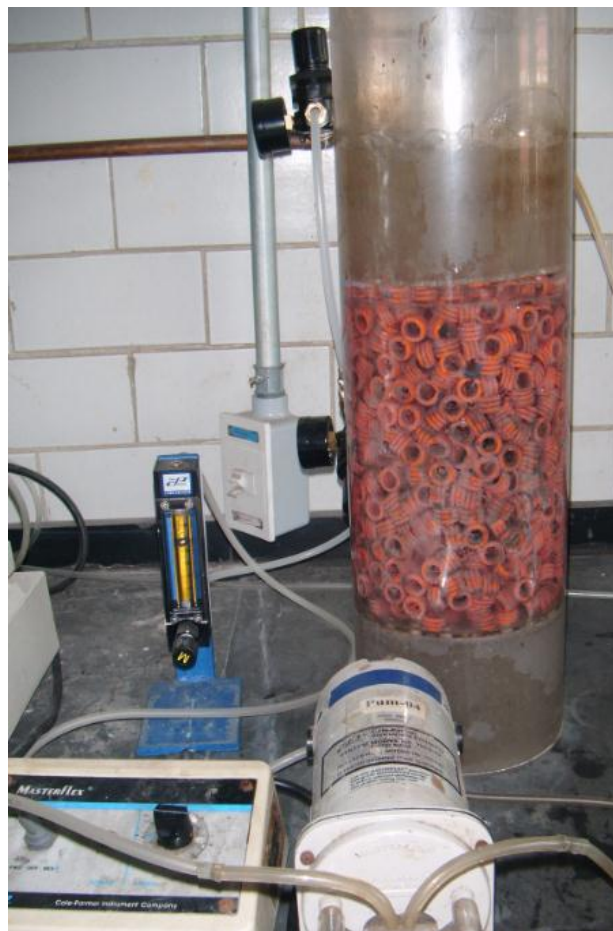
Figura 3. 4 Reactor biológico de lecho empacado en continuo.
