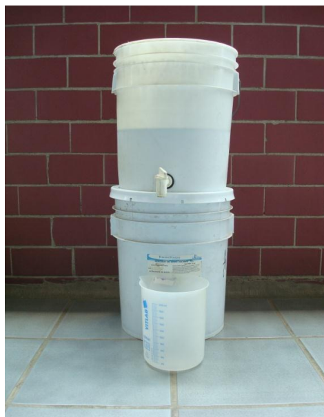
Figura 4. 1 Sistema de decantación
