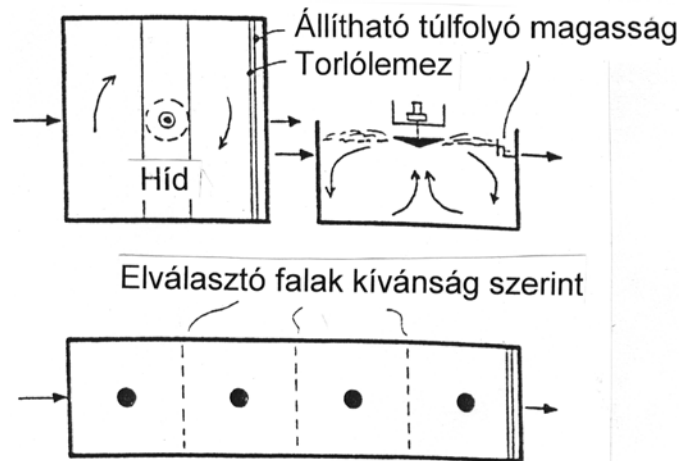
13. ábra: Levegőztető medencék függőleges tengelyű felületi levegőztetővel.
