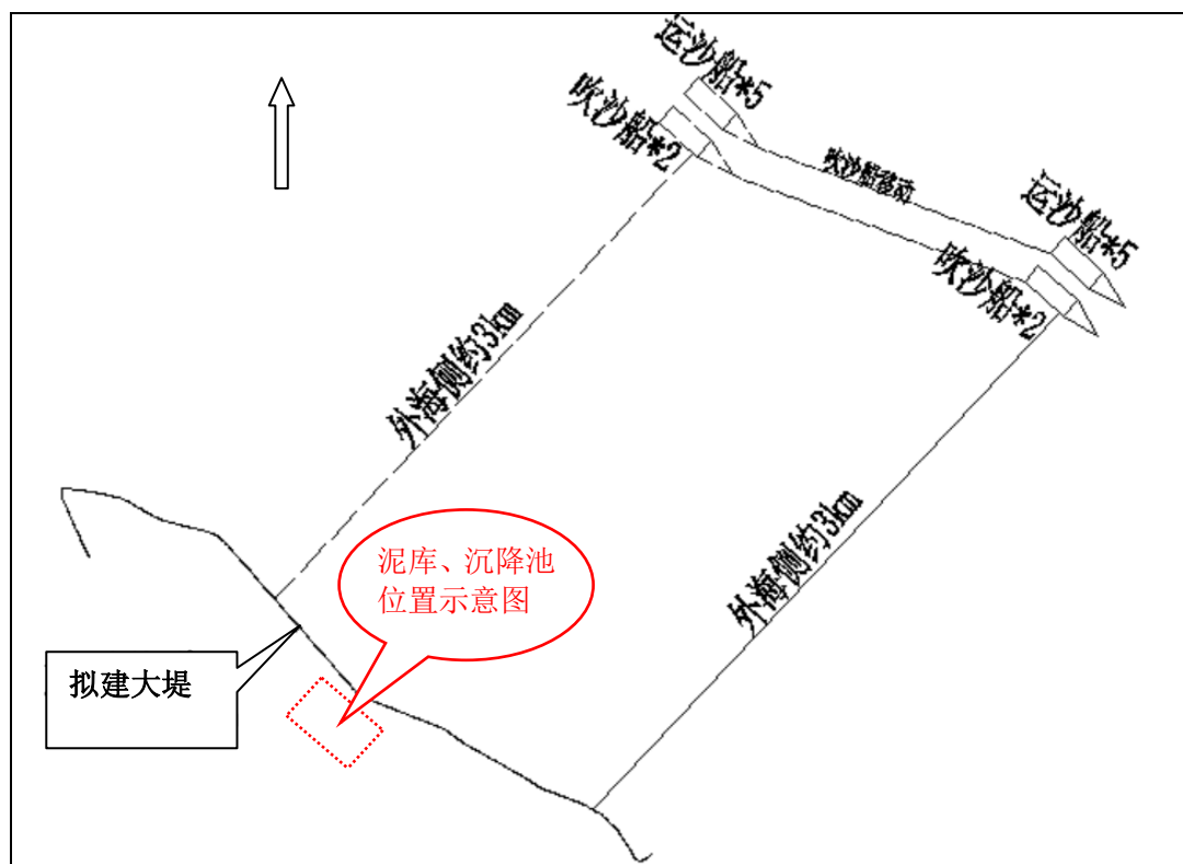
图 2.5-3 海堤加固吹运沙船布置情况
