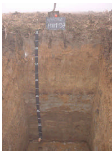
Sali Vercellese (Vc): disponibilità di ossigeno moderata come evidenziato dai colori grigi oltre gli 80 cm di profondità.
