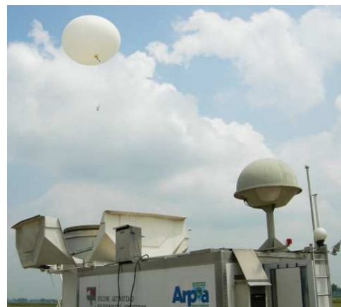
Fig 4: Lancio della radiosonda presso Cuneo Levaldigi
