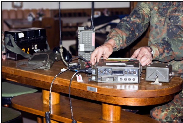
Ein Blick auf das Funkgerät SEM 80 mit Handapparat, Lautsprecher, Adapter und Diskriminator Foto: Björn Reiter
