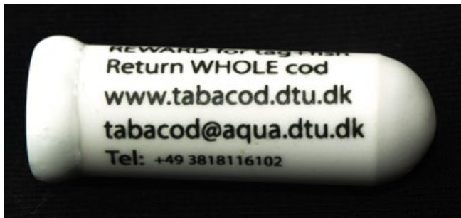
Rys. 2. Znaczek typu DST (Data Storage Tag) o długości 4 cm. Oprócz daty i czasu, znaczkę tego typu rejestrują także temperaturę i głębokość wody, w której przebywał dorsz.
