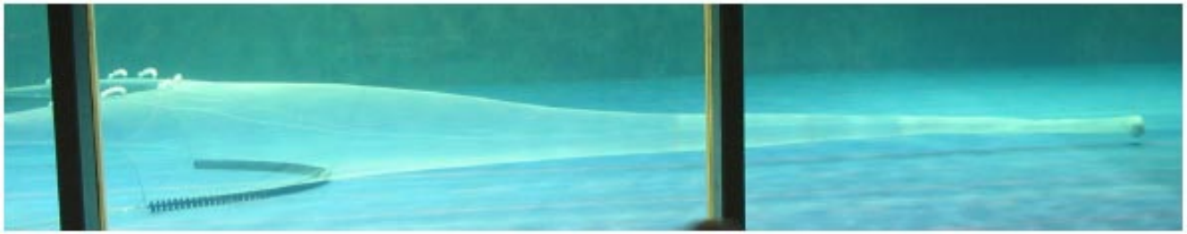
Model zestawu włoka H-Trawl T90 wykonanego całkowicie w technologii T90, podczas demonstrowania jego pracy w kanale obiegowym
