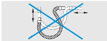
Nicht an den Schlauchenden überbiegen, sondern durch Rohrbogen umlenken
