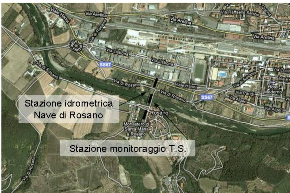
Figura 3-20: Immagine satellitare del tratto del fiume Arno in corrispondenza della stazione di monitoraggio del trasporto solido (linea tratteggiata) e della stazione idrometrica di Nave di Rosano.
