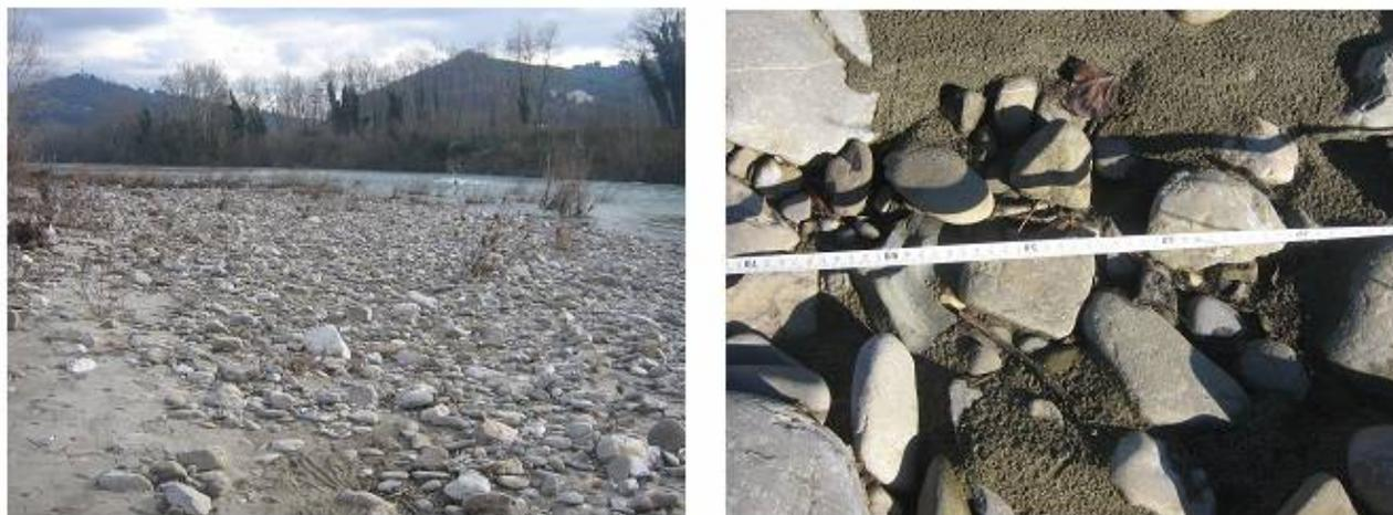
Figura 3-24: a) foto del sito di campionamento 1; b) predisposizione del campionamento superficiale di tipo *pebble counts*.
