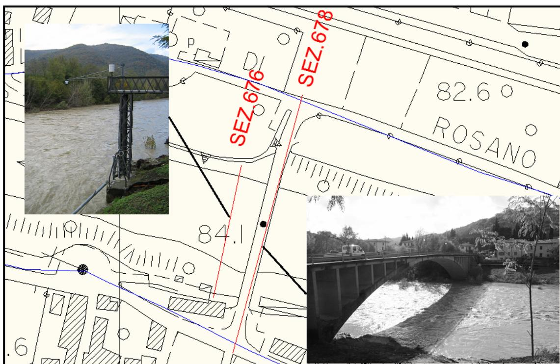
Figura 6-19: Planimetria della sezione dove sono state effettuate le misure (678) e della sezione in corrispondenza della quale è ubicata la stazione di monitoraggio dei livelli (676).
