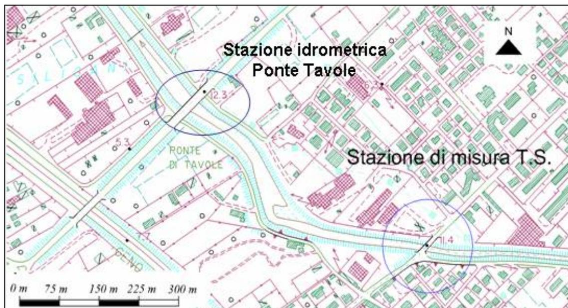
Figura 3-12: Inquadramento planimetrico della stazione di monitoraggio del trasporto solido sul fiume Versilia e della stazione idrometrica di Ponte Tavole.
