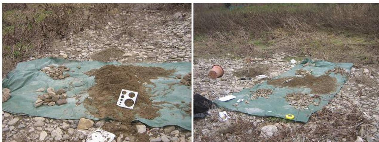
Figura 3-25: fasi del campionamento volumetrico (sito 1).
