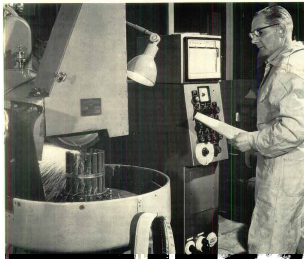
Provslipare Gösta Stenfeldt testar slipband för metallbearbetning
