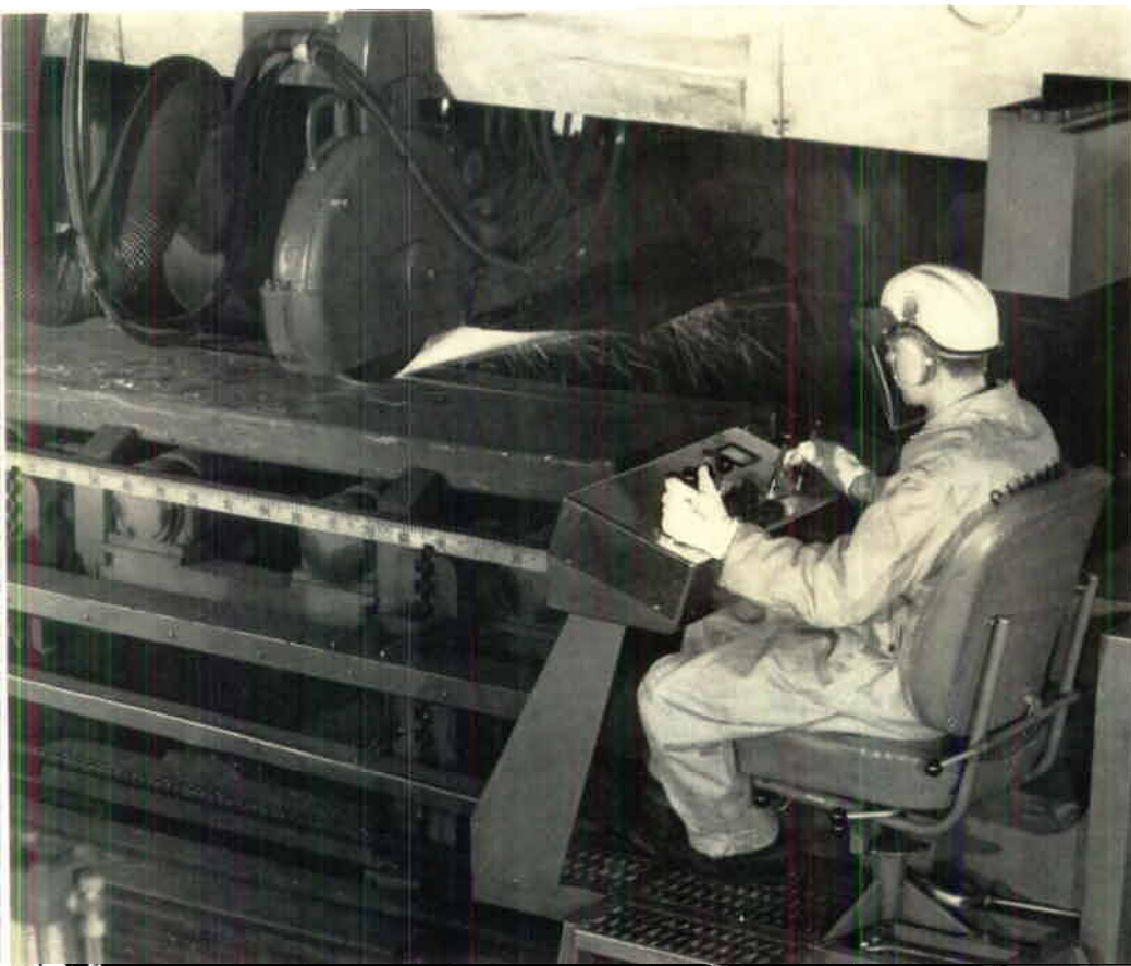
I denna ämnesslipmaskin av egen tillverkning provslipar man golvslipskivor på 4—5 ton tunga stälämn. Operatören heter Leif Rosenberg.
