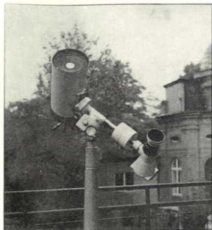
Amatérská astrokamera 56/250 jako přídavné zařízení k Maksutovovu zrcadlovému teleskopu MENISCAS 180/1800 ◀
