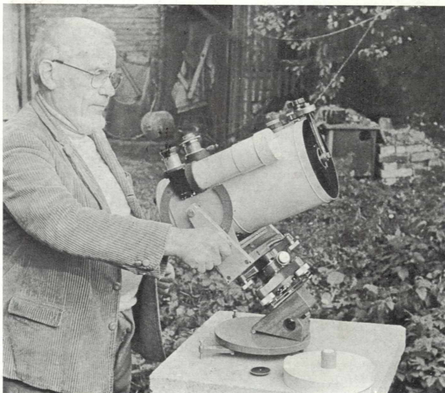
Snímek zachycuje pozoruhodný malý dalekohled, vhodný pro valnou většinu amatérských pozorování. Jde o reflektor 157,5/395/1600, který může pracovat jako Newtonův nebo Cassegrain — Nasmytův reflektor. Optiku vybrousil prof. Gajdušek, tubus a celou montáž vyrobili Miloš a Václav Hübnerovi (foto K. Láška).
