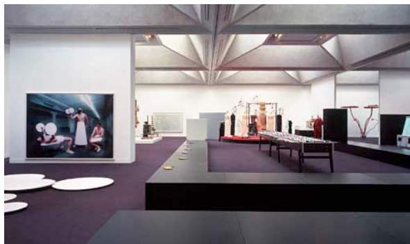
Εικόνα 22: Το ντυμένο, με μοκέτα ,δάπεδο στην εικόνα, απορροφά τον ήχο και δημιουργεί την αίσθηση ηρεμίας σε ολόκληρη την έκταση του. Επιπρόσθετα, το σκούρο του χρώμα, απορροφά το φως προσθέτοντας περισσότερη αίσθηση ηρεμίας στον χώρο
