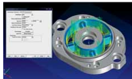
V nové verzi 5.0 patří mezi inovace i update tříosého obrábění na ose Z pro vysokorychlostní dokončovací HSM operace
