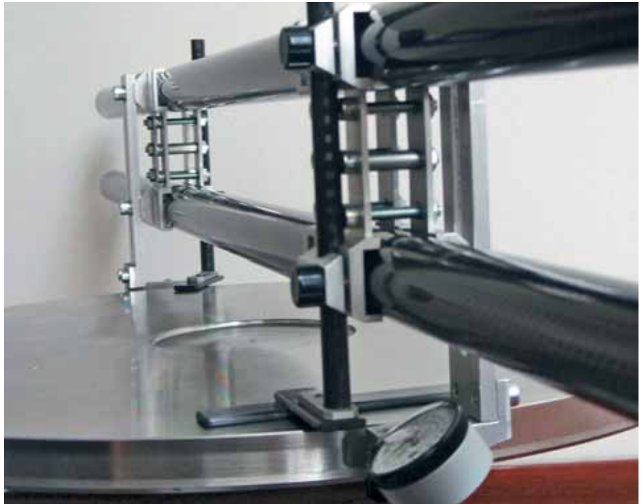
Zakázkový odpich z kevlarových prvků na kontrolu vnitřních a vnějších průměrů velkorozměrových součástek (i několik m)
