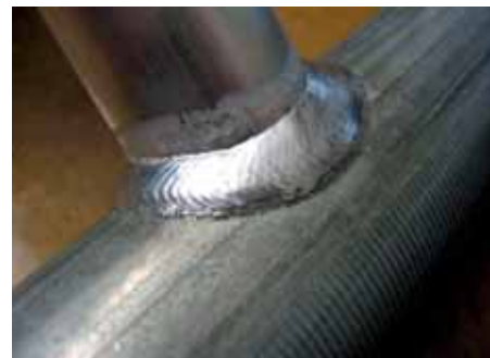
Příklad spoje hliník - ocel metodou CMT
