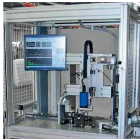
Automat na kontrolu kroužků ložisek se systémem OptoSurf
