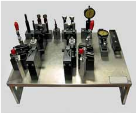
Mezní prostorové měřidlo plechových součástek karosérie
