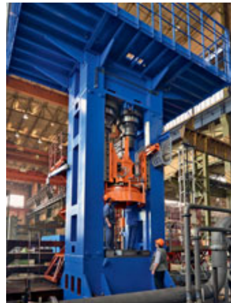
Hydraulický lis CTHN 3000 před dokončením v montážní hale ŽĐAS
