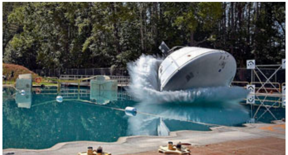
Test MPCV (dříve Orion): Kabina opakovaně spouštěná z jeřábu při rychlosti 55 mil za hodinu do zkušebního bazénu Hydro Impact ve výzkumném centru NASA při srpnových zkouškách simuluje nejhorší možný scénář přistání s poloviční šancí na přežít a má ověřit stabilitu modulu
