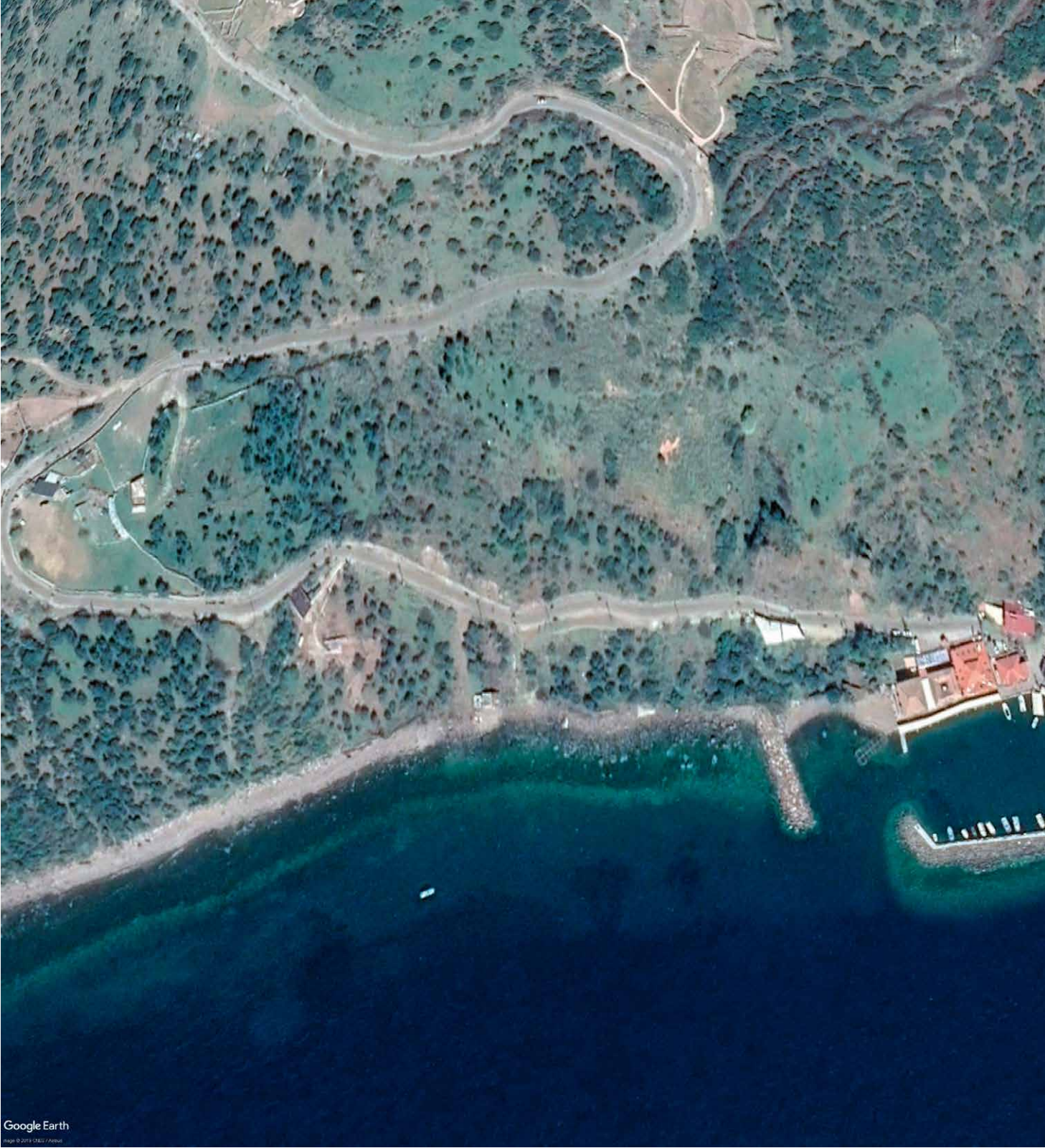
Fig. 6: Yüksek kıyılar önünde, su altında kalmış liman yapılarına bir örnek: Assos limanı. Arkaik Çağdan beri varlığı bilinen mendirek yapısı (Arslan vd. 2018). Güncel mendirek altında da su altında kalmış eski bir mendirek bulunmaktadır. Fig. 6: An example of submerged harbour structures on a steep mountain coast: Assos harbour of the Archaic period (Arslan et all. 2018). There is an old breakwater too, under the current breakwater.
